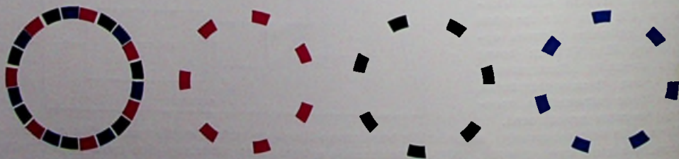
Fig. 19 - Eén cirkel samengesteld uit de drie primaire kleuren vóór de camera zal in elk van de drie vidicons als een uit stippen bestaande cirkel worden gezien. Maar ieder buisje ziet slechts zijn eigen kleuren.
